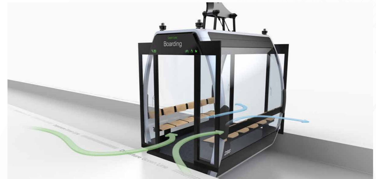
ABBILDUNG 3-12: Seilbahn-Kabine, getrennter Ein- und Ausstieg bei der neuen TRI-Line von Doppelmayr ermöglicht noch schnelleren Fahrgastwechsel (© Doppelmayr Seilbahnen GmbH)
