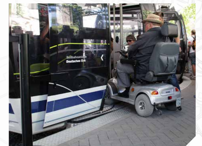
ABBILDUNG 4-1: Barrierefreier Ein- und Ausstieg der Seilbahn in Koblenz (© Doppelmayr Seilbahnen GmbH)
