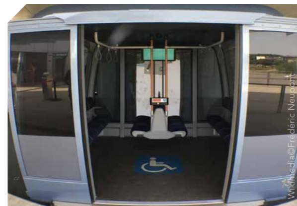
ABBILDUNG 3-11: Barrierefreier Ein- und Ausstieg der 3S-Bahn in Koblenz (© Doppelmayr Seilbahnen GmbH)
